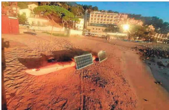
**El invento.** Diseñado y construido por el propio Ymbern, el kayak solar alcanza una velocidad máxima de hasta 5,5 nudos. La embarcación, que cuenta con dos paneles para su alimentación, es un prototipo al que el ingeniero ve futuro y en el que sigue trabajando para perfeccionar el sistema.
